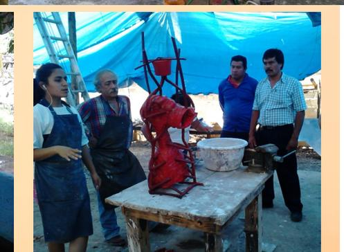
*Proceso del Águila Republicana: Primero se dibujó del tamaño real, en seguida se modeló en estructura de hierro y malla, en tamaño original de 4.80 mts. de envergadura y 1.40 mts. de alto, posteriormente es modelada en plastilina, para luego cubrirla con moldes en yeso, cada molde es bañado de cera, debiendo estar las figuras en agua, para que no se deformaran antes de ser*
